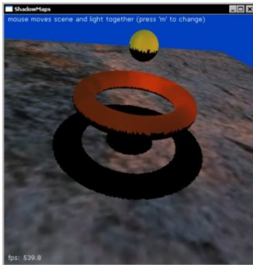
Figura 6.2. Una impostazione errata del bias può generare imperfezioni sui bordi tra luce e ombra. Notare in particolare gli effetti dello Z-Fighting sul toro e sulla sfera.
