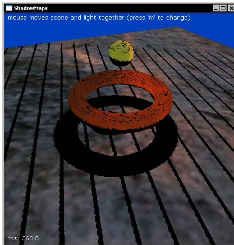
Figura 6.4. Nell'implementazione base delle shadow map si verifica il fenomeno dell'acne.
